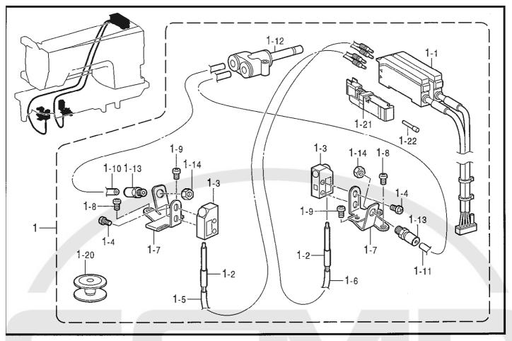
ログラスター 151-615-213 Q . 糸切レ感知関係 (オプション部品) / Thread breakage detector mechanism (Option parts)
